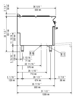
Electrical inlet (power) ΕI EQ Equipotential screw
